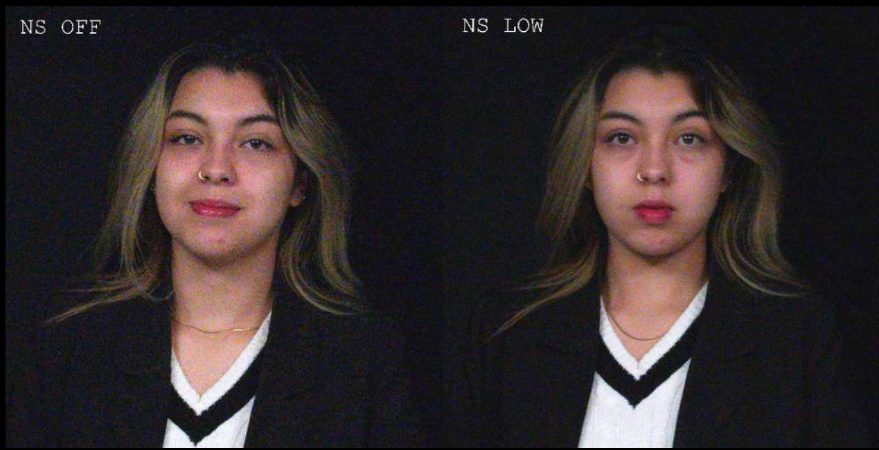
Figura 25. Slog3-SGamut3 convertido a 709 con Davinci resolve y corregida la Subexposición de -4 stops
